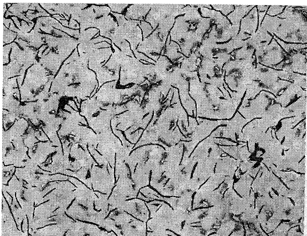
図3 ダライ粉を使用して溶解した鑄鉄の顕微鏡組織 100 μm
