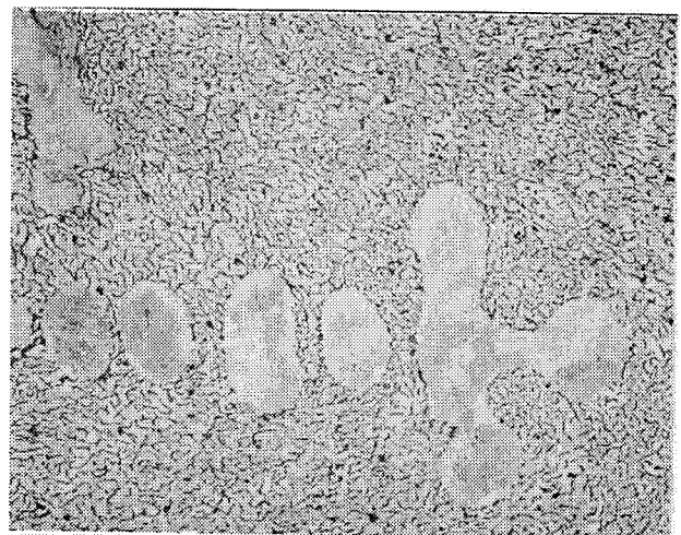
図10 Fe-C純系、(G-1)、凝固速度 0.01000cm/s 鑄放しの組織 (腐食ナイタール)
