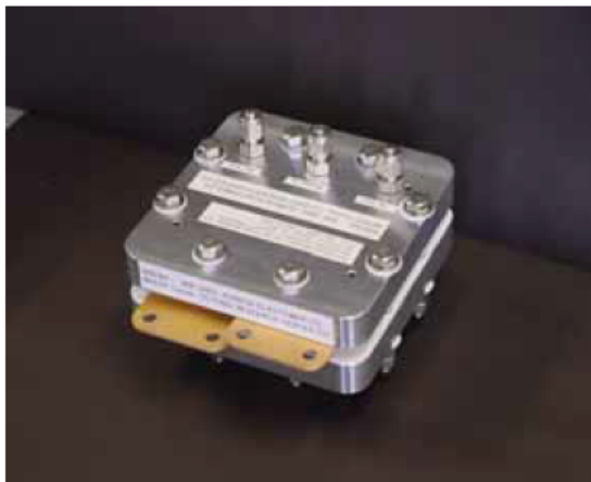
新しいセパレーターを組み込んだ 固体分子形燃料電池 (単セル)
