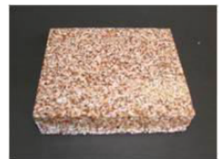
廃陶磁器ガラを用いたインターロッキングブロック
