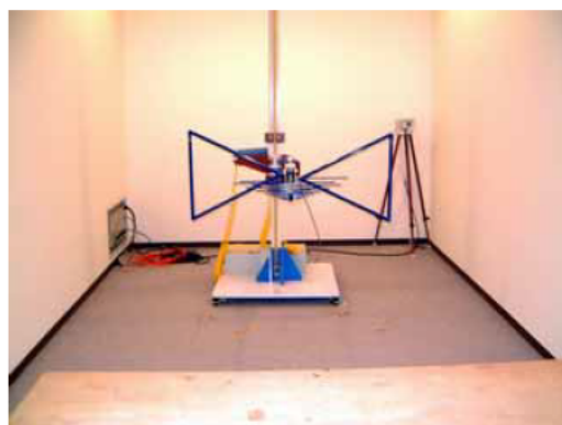
電波暗室でのイミュニティ試験
