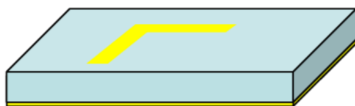
解析モデル (プリント基板上の屈曲配線)
