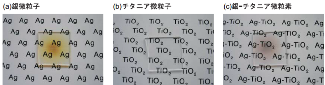
図2 (a)銀、(b)チタニアと(c)銀-チタニア微粒子を沈着させたシリカガラス基板の写真 (基板のサイズ20×20 mm 2 )
