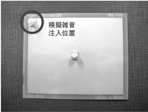
(a) 矩形平行平板共振器 (横幅 100 mm, 縦幅 80 mm)
