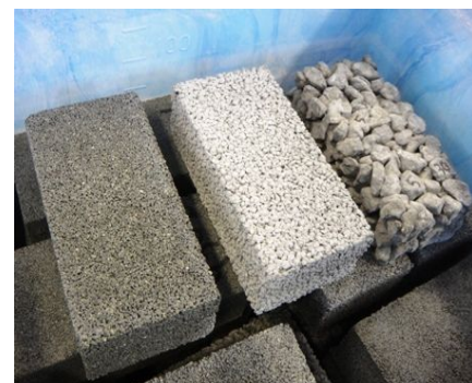
(b) 角柱供試体
