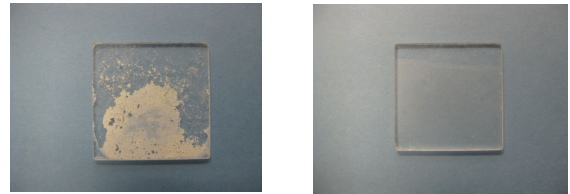
図2 溶液を塗布した基板の焼成前後の外観写真 左：焼成前 右：焼成後
