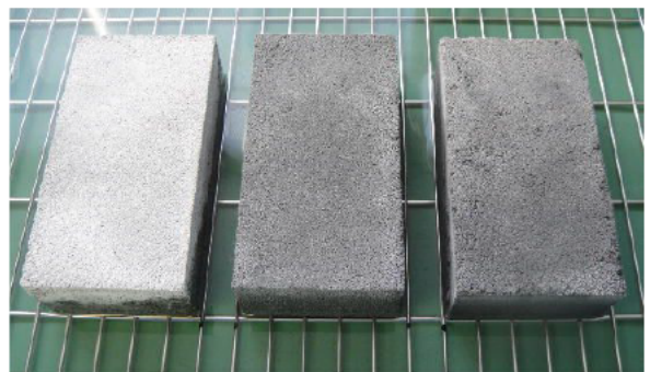
図 6 吸水性試験の一例（使用骨材：電気炉酸化スラグ B, 設計空隙率：左から, 10, 20, 30%）
