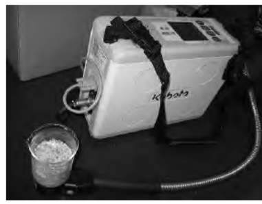
④インタラクタンス法による未粉碎試料の測定
