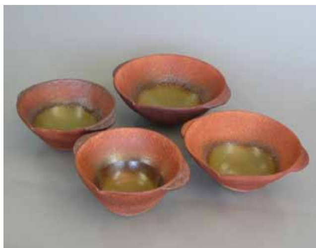
図 1 果実焼却炭由来の灰を釉薬原料として用いた試作品『塩鍋』
