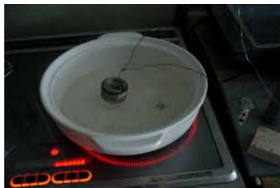
図5 発熱体の損傷試験
