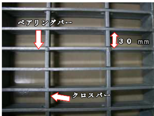
図3 測定対象のグレーチング
