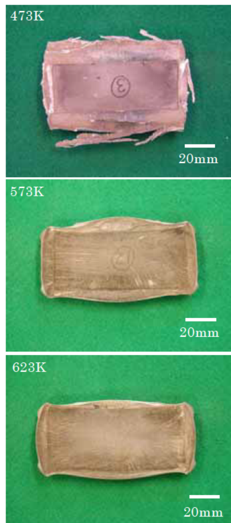
図 3 D 材の鍛造後の外観写真 (圧下率：50%)
