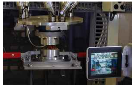
図 5 6 軸材料試験機 ( 上 : 全景 下 : 試料取り付け位置 )
