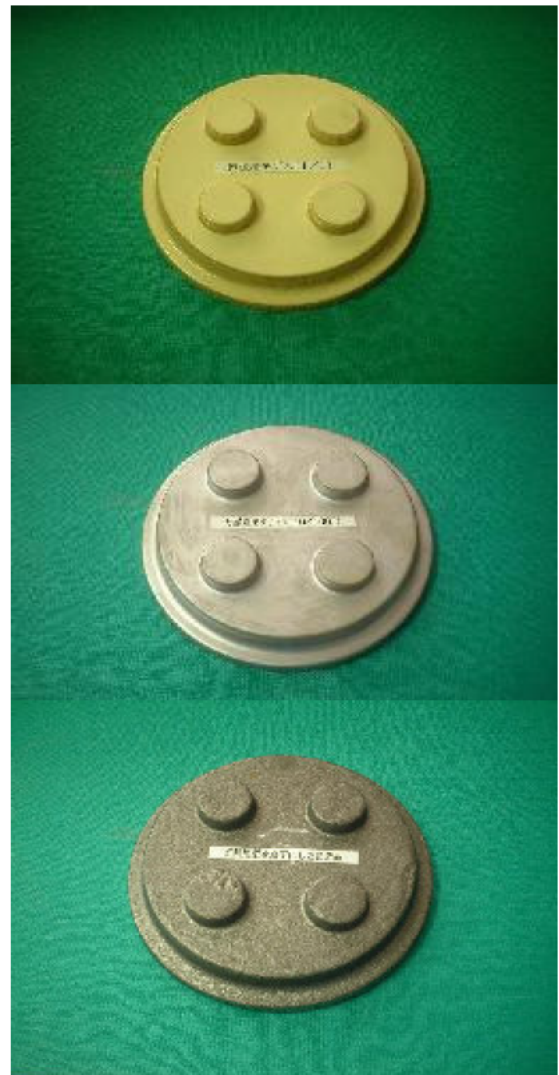
図4 紙積層で成形した铸造用模型 上段：意匠検討用モデル（1000/1000） 中段：铸造用模型 （表面離型剤塗布，1010/1000） 下段：製品（生砂造型法による）
