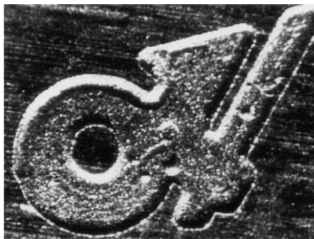
図4 ハイ \pi 電極による高アスペクト比穴加工
