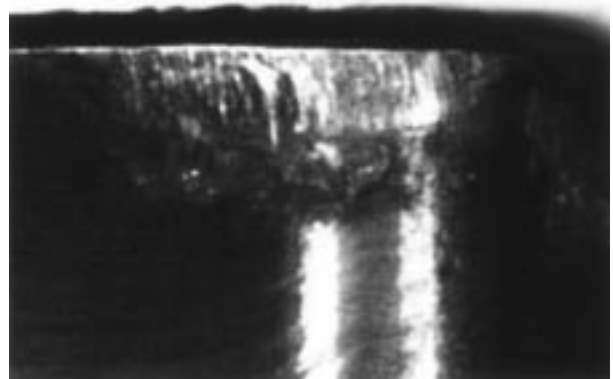
切削速度120m/min. 切削距離2km 送り0.1mm/rev.
