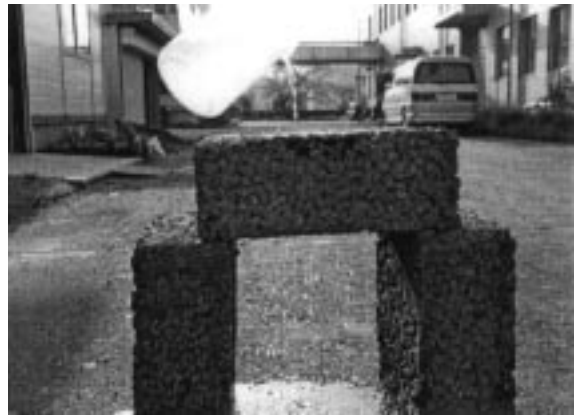
図2 ポーラスコンクリートブロックの上面から水を流している様子
