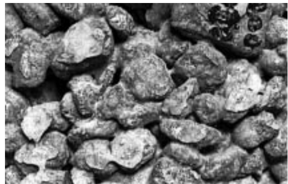
図1 ポーラスコンクリートの構造
