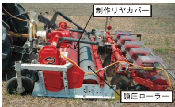
図1 全面鎮圧ローラを装着した 小明渠浅耕播種機
