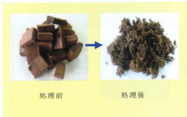
得られた爆碎処理物は、木部導管等が物理的な解纖を受けてハニカム（蜂の巣）構造になることを走査顕微鏡で確認し、これらに土壌病原菌などに拮抗作用を示すバチルス属菌を定着させることができ、有用微生物の担体（住か）として利用できます。また、爆碎処理に伴って生成される酢酸を水洗除去することで、培養土などの農業用資材として利用できることも確認しました。とくに現在の家庭用生ごみ処理機（発酵型）用の交換チップは、高額であることから十分に本資材による対応が可能な資材であると言えます（図）。
