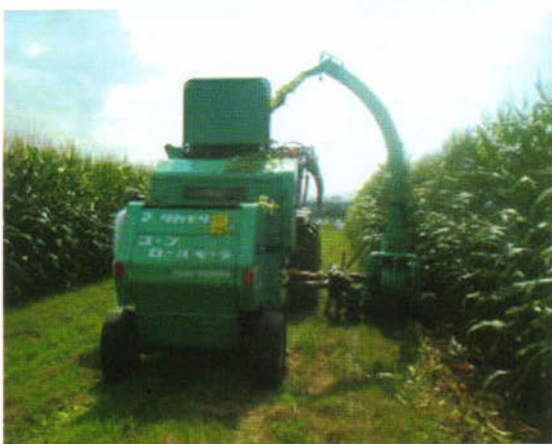
写真1. 新断型ロールベアラの作業状況
