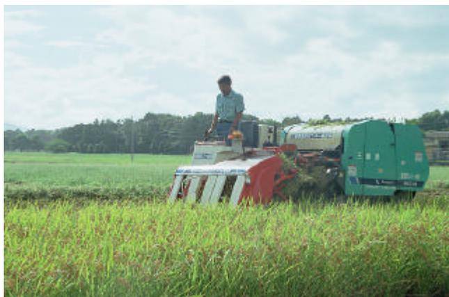
写真1 飼料イネ用ロールペーラによる収穫・梱包作業
