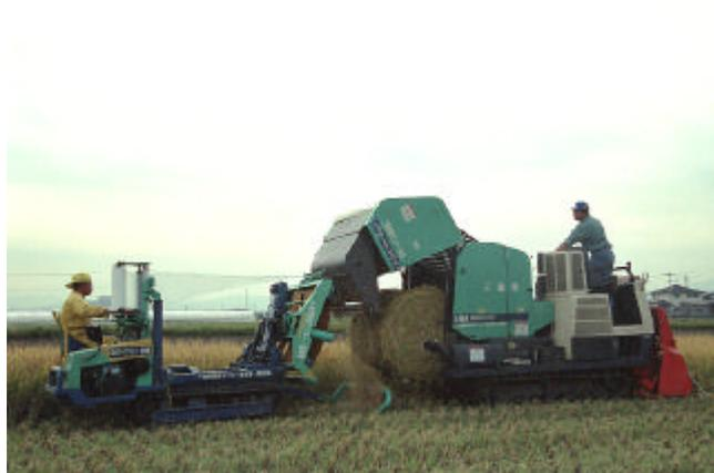
写真2 排水不良田における両作業機械の組作業（直接荷受け）
