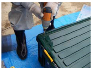
取り除いた蓋の一部にかぶせるポリカーボネイト(アクリル板)の加工
