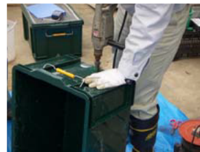
段々ドリル又はホールソーで排水口を開けます
