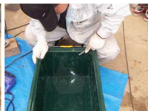
段々ドリル又はホールソーで通気口を開け、防虫ネットを張り付ける
