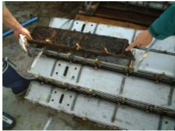
冬季は堆肥原料の水分が高いため、攪拌用の刃にからみつき、腐食や劣化が生じやすい。このため、刃に付着した堆肥を掻き落とす作業が必要であり、3年に1度は、刃の交換を行っている。
