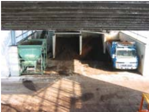
ストックヤードで生成した堆肥をふるいにかけて、粒状別に保管を行っている。
