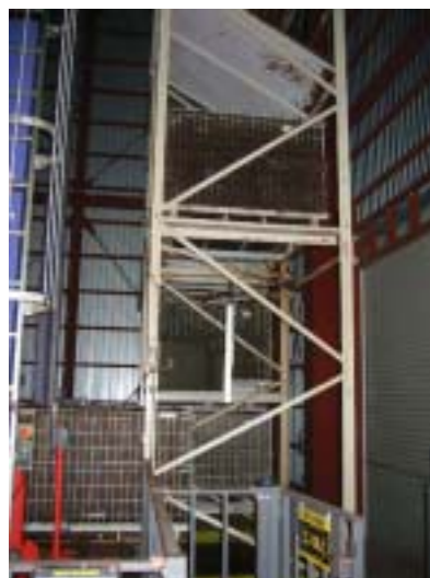
立体駐車場のような構造でパレットが管理されて、省スペースである。反転操作等は自動で行われる。
