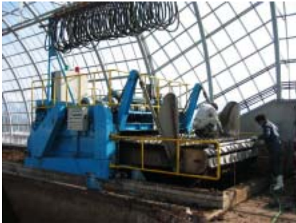
堆肥化の攪拌機。通常は一人で運転を行う。
