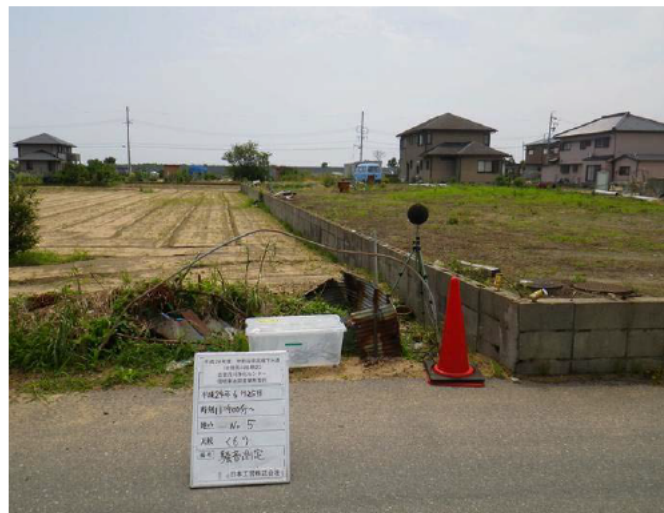
写真 2.2-1 騒音測定機器設置状況
