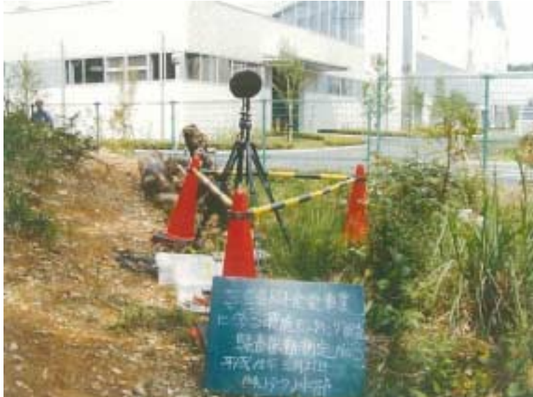
写真4 - 3 騒音・振動調査 測定状況 (No. 3 : 平成 15 年 5 月 21 日 ~ 22 日)
