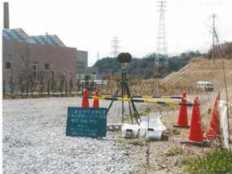
写真 4 - 1 騒音・振動調査 測定状況 (No. 1 : 平成 15 年 3 月 26 日 ~ 27 日)
