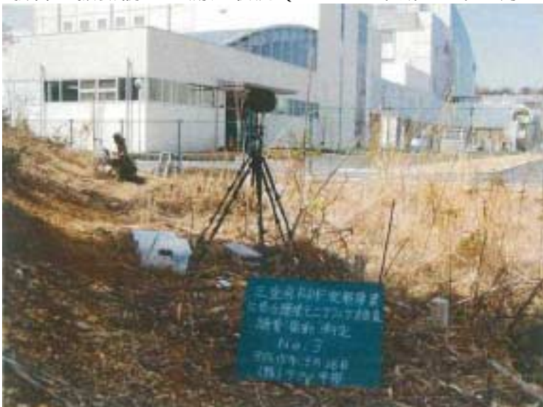
写真 4 - 3 騒音・振動調査 測定状況 (No. 3 : 平成 15 年 3 月 26 日 ~ 27 日)
