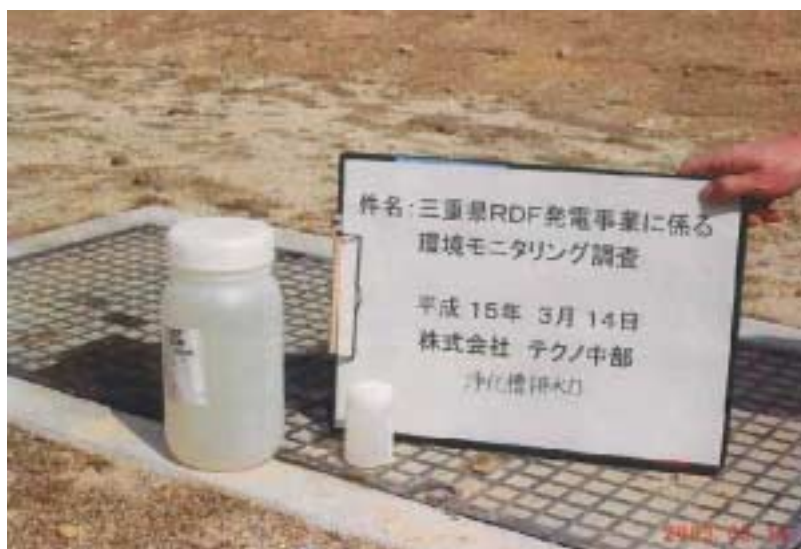
写真 3 - 1 水質調査 試料採取状況：浄化槽排水口（平成 15 年 3 月 14 日）
