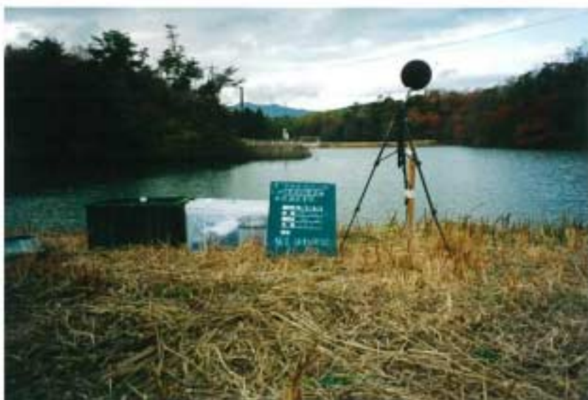
写真 騒音・振動測定風景（平成 13 年 12 月 18 日： 3）
