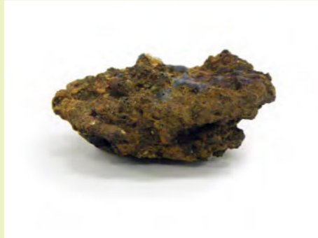
わんがた てっさい かじ 椀形の鉄滓。鍛冶を行う時の炉の底にたまる鉄のかすのようなものです。古代の竪穴住居から出土しました。
