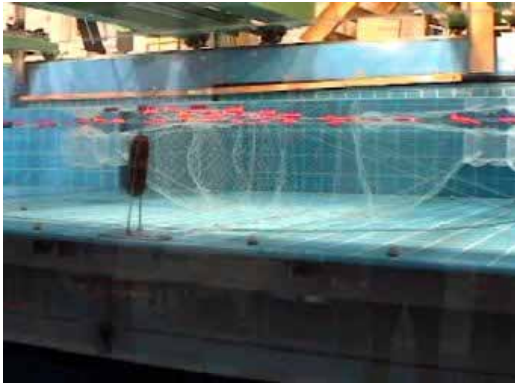
回流水槽による急潮再現実験
