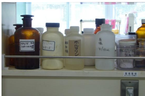
写真 4-6-5 耐震対策が施されていない棚
