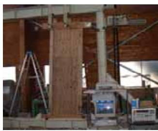
三層パネルのせん断試験
