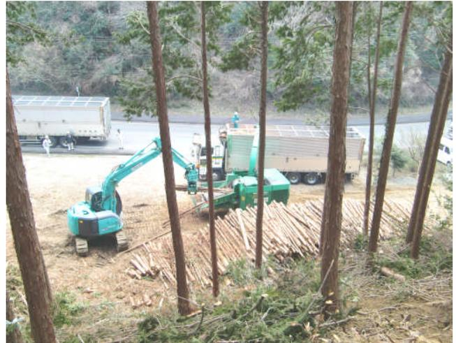
チップ化、原木運搬・・・移動式チップパーでチップ化し、トラック運搬または原木をトラック運搬
