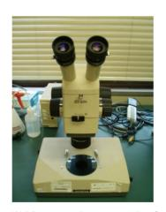
これは実体顕微鏡といいます。生物顕微鏡と形は似ていますが、こちらは数倍~40倍ぐらいの倍率で観察するための顕微鏡です。見たいもの(昆虫、草花など)をそのまま載せて観察することができます。また、実体顕微鏡は物を立体的に捉えることができるので、検体表面の細かい凹凸も観察できます。精密機械の組み立てや脳外科手術に使う顕微鏡も実体顕微鏡の仲間です。
