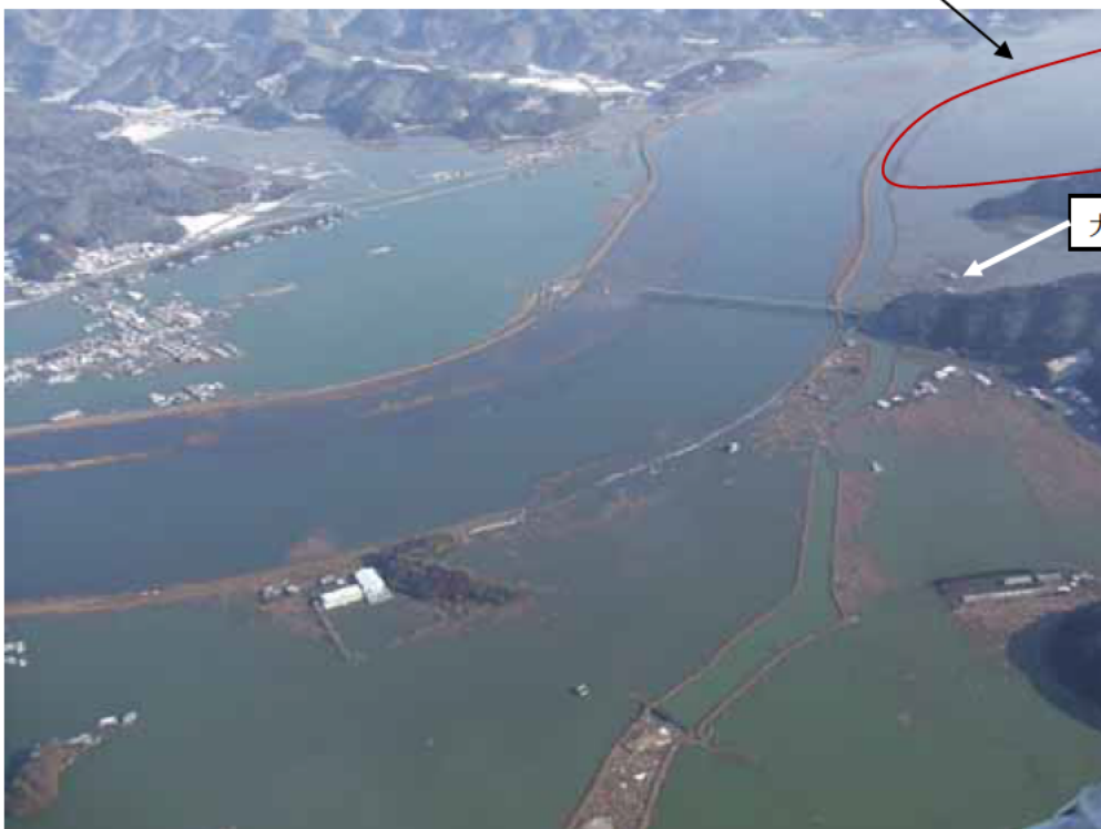
北上川周辺の浸水と新北上大橋の落橋（河口から約 4km 地点）
