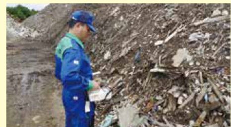
空間線量率測定の様子 (久慈市内の仮置き場)
