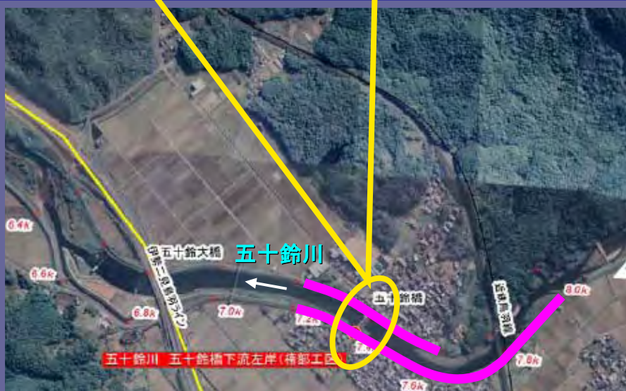
堤防高-余裕高評価で流下能力不足箇所
