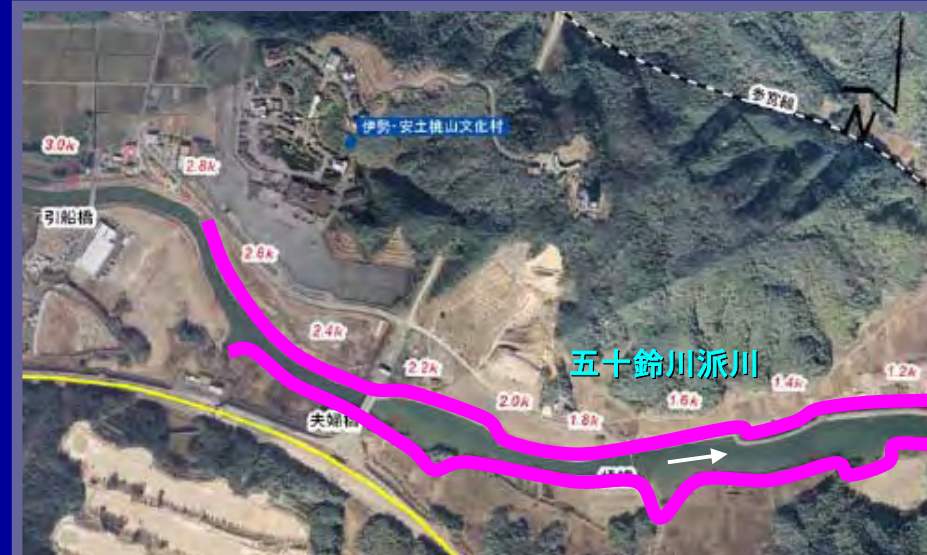
堤防高-余裕高評価で流下能力不足箇所
