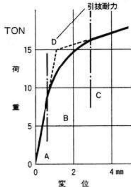
図4-1 ロックボルト引抜試験
