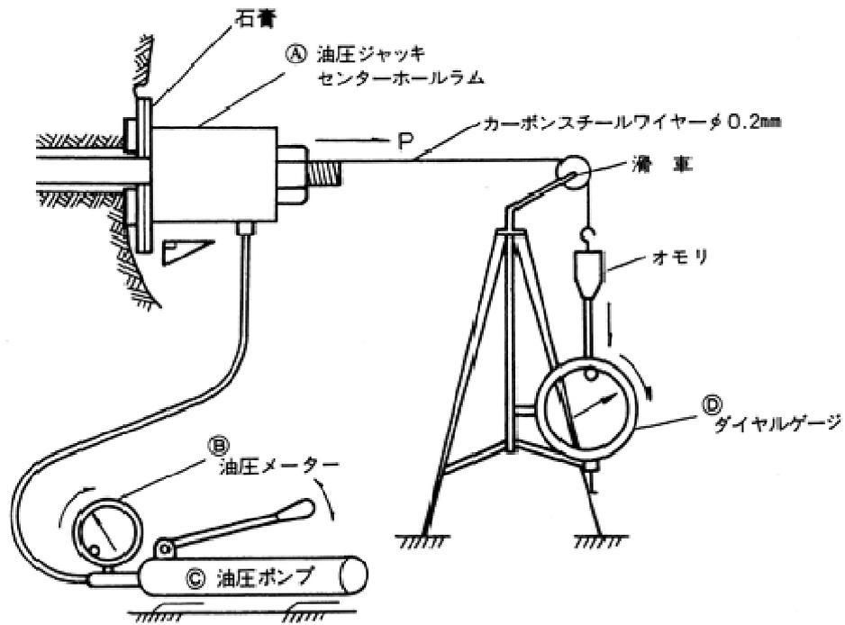
図 4 - 3 引抜試験概要図
