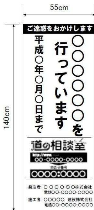
(様式4) 工事説明看板 (占用企業工事)
