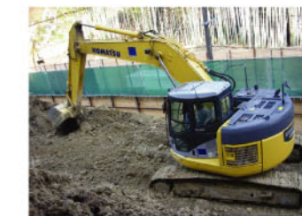
排出ガス対策型建設機械を使用した工事(北勢県民局桑名建設部)
