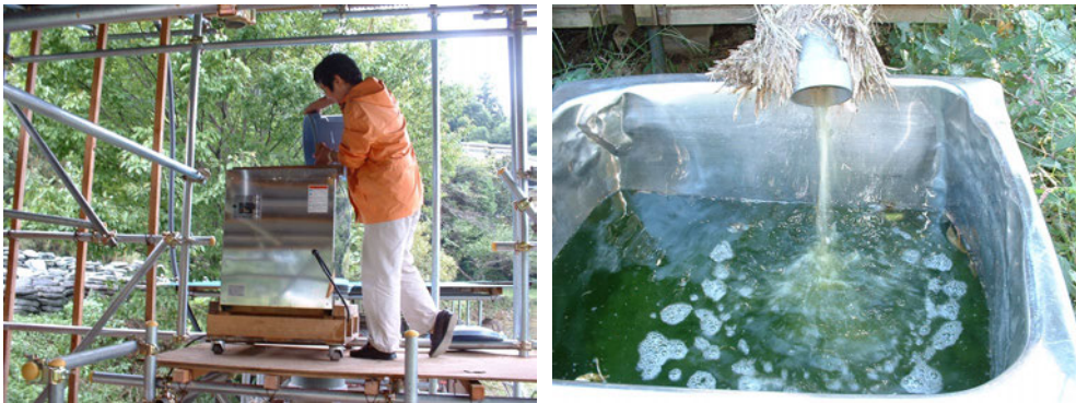
図表 3 - 18 生ごみの投入風景とプラントで生成された液肥
