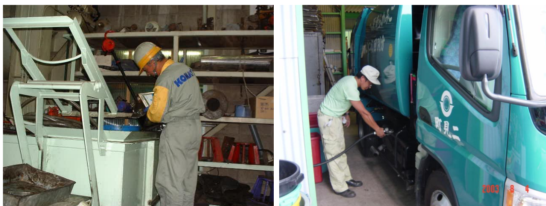
図表3 - 25 精製プラントへの投入とBDFのごみ収集車への給油のようす
