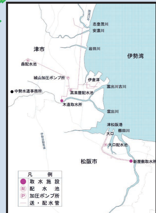
中伊勢工業用水道事業概要図 松阪工業用水道事業概要図
