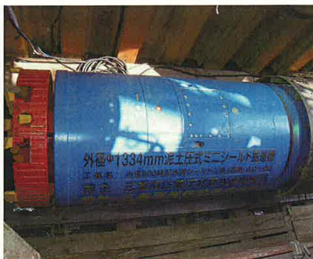
内径800mm配水管シールド工事
